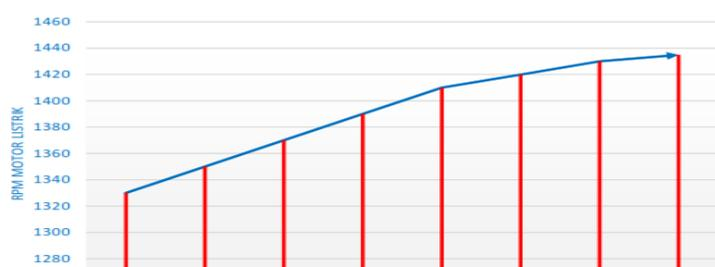
**Gambar 7.** Grafik Korelasi nilai resistansi *dimmer* dengan RPM motor listrik
